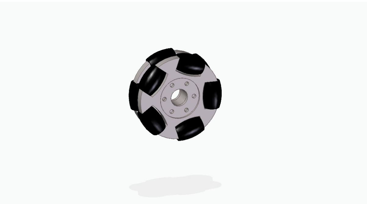
Abbildung 2.13.: Modell eines omnidirektionalen Rades
