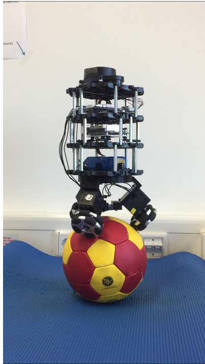
Abbildung 5.5.: Aufbau des realen Ballbots.
