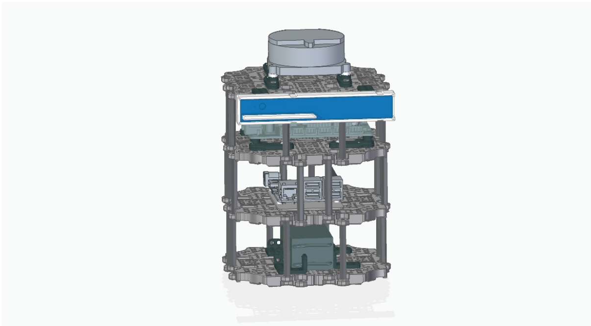
Abbildung 2.8.: Oberbau, bestehend aus vier Etagen
