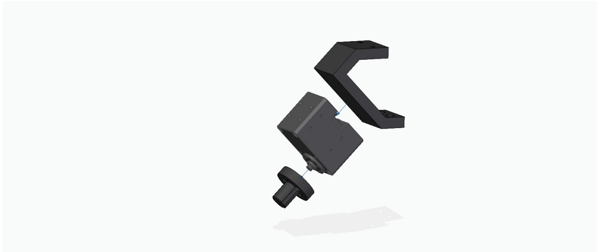
Abbildung 2.12.: Antriebsvorrichtung bestehend aus Mitnehmer (unten), Motor (mitte) und Motorenhalter (oben).
