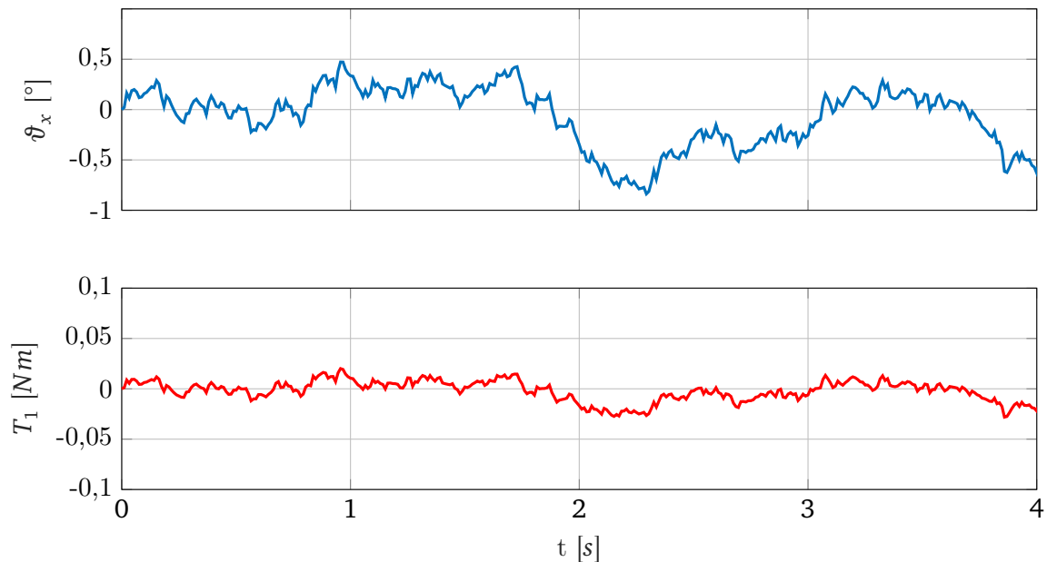
Abbildung 3.4.: Rauscheinfluss auf den Winkel \vartheta_x und auf das reale Drehmoment T_1 in der Simulation
